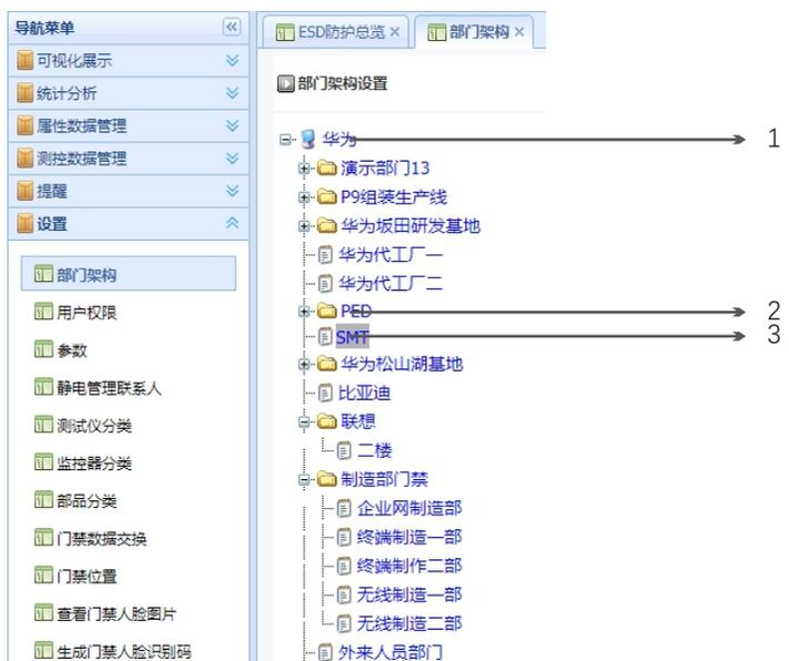
将设备状态监控器和设备设置在同一个组，同一个信道号，把该监控器的ZIGBEE地址设置好再点击保存就可以了；
